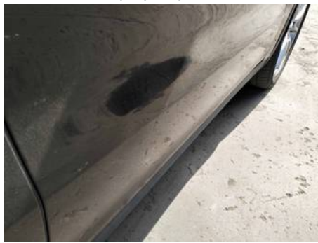
Porte avant droite (Impact)
